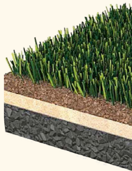
Aufbau eines Kunstrasens mit elastischer Tragschicht, Infill und Rasenfilament. (v. u. n. o.) Foto: Polytan
