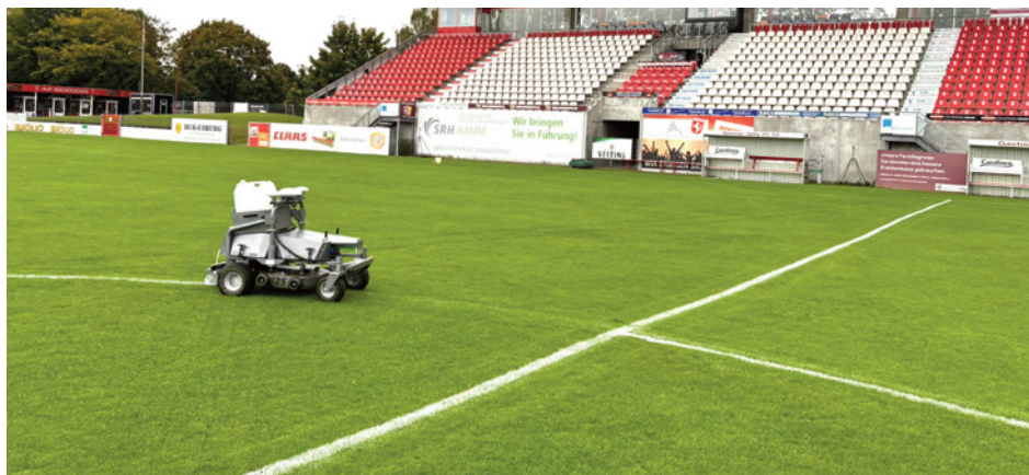
Der Mäh- und Linienroboter RM21 beim Markieren eines Fußballplatzes. Foto: GPS-FARMING
