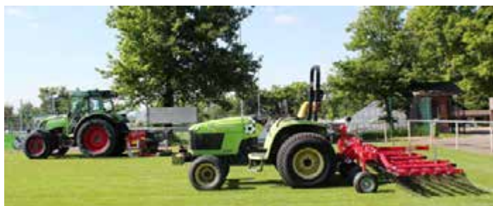
Moderne Pflegemaschinen von Sportstättenbau Garten-Moser zum Striegeln und Tiefenlockern.
