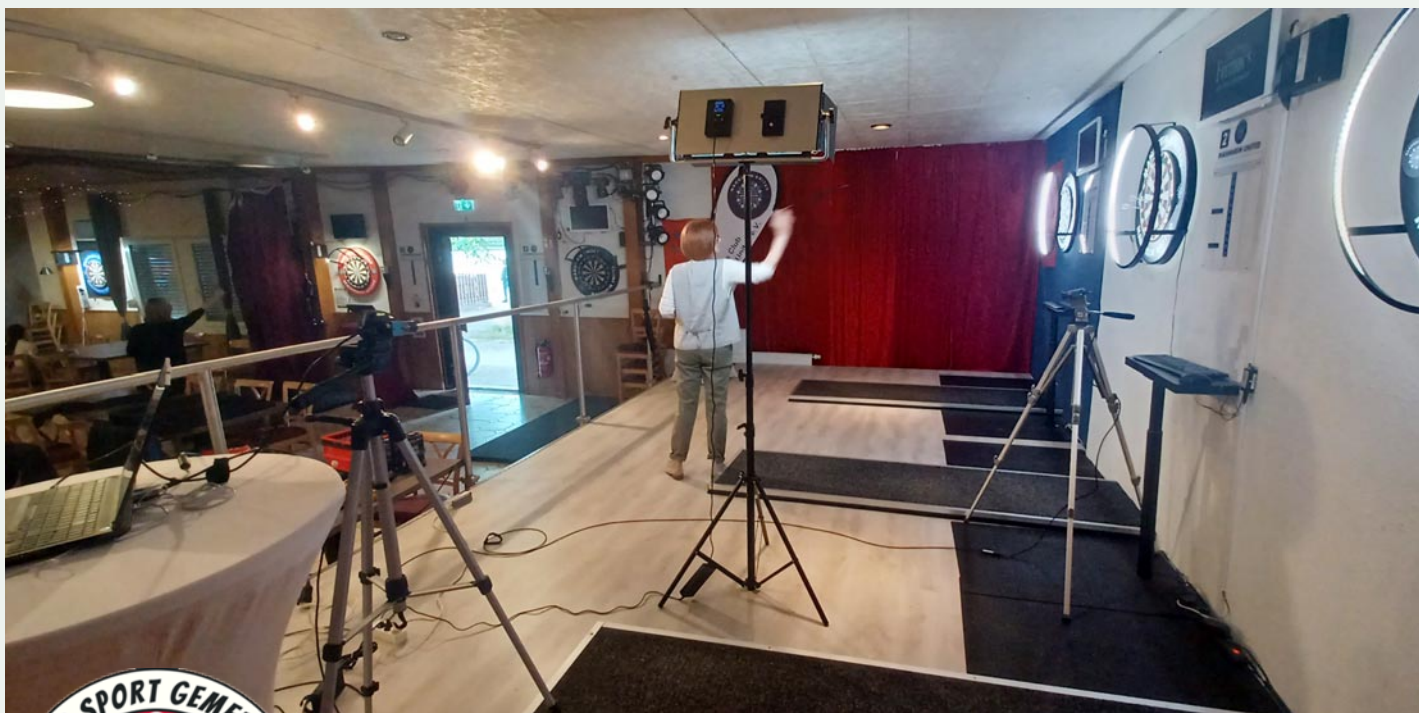
Gesamtblick auf das Equipment – ganz links auf dem Stehtisch: Notebook mit Aufzeichnungs- und Auswertesoftware. Daneben auf dem ersten Stativ von links: Industriekamera zur Aufzeichnung von der Seitenansicht. Mitte im Bild: Lichtstativ zur seitlichen Ausleuchtung (zusätzlich zur Bühnenbeleuchtung von hinten an der Decke); rechts: Industriekamera zur Aufzeichnung des Wurfes von vorne. Foto: Verein
