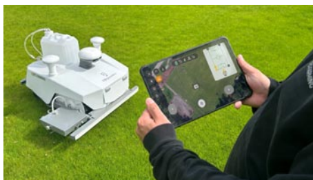
Per Tablet gesteuert: Der PaintMaster Pro unterstützt Vereine bei der präzisen und wiederholbaren Linienmarkierung.
