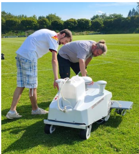
Teilnehmende begutachten den Markierroboter, der in Kürze und mit Präzision Spielfeldlinien aufsprüht.
