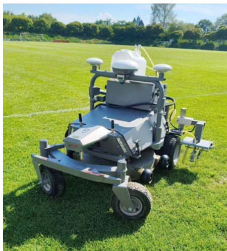
Der Moxy Pro als Kombi-Gerät kann autonom mähen und markieren.
